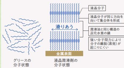
近年、真空・クリーン・高温等の厳しい特殊環境下で使用される直動案内機器に対して、これらの環境下に適する性能に加え、優れた潤滑性や安全性など、多様な性能が求められています。こうしたニーズにこたえるため、高性能潤滑剤「液晶潤滑剤」を封入した**世界初の液晶潤滑リニアウェイ**を開発しました。グリースとはまったく異なる構造を持つ潤滑油の使用により、特殊環境下におけるリニアウェイの飛躍的な性能アップを図り、組込み機械の信頼性向上に貢献します。
